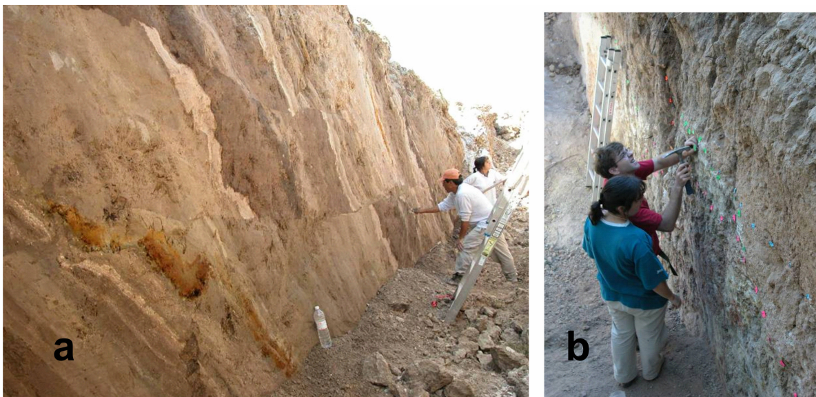
Figura 10.- Las trincheras permiten analizar directamente las fallas que han tenido actividad. Este método de análisis directo, permite caracterizar la fuente de la sismicidad en una zona, estableciendo diferentes parámetros como periodo de retorno o el tipo de falla . Este tipo de análisis es necesario para la inclusión en el catálogo sísmico de terremotos que presentan periodos de retorno muy elevados: a) trinchera en materiales volcánicos (Michoacán, México), b) trinchera en materiales sedimentarios en Hellín (Albacete) (Fotos: M.A. Rodríguez-Pascua).
