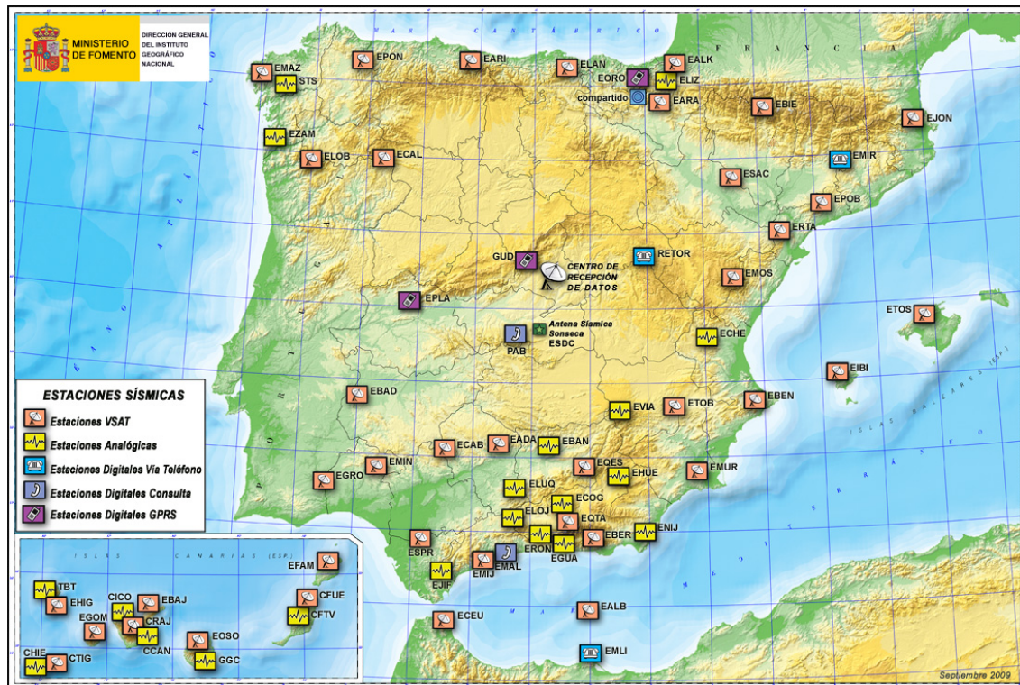
Figura 16.- Red de alerta sísmica. Mapa de situación de los distintos tipos de estaciones de registro sísmico en la Península Ibérica. El Instituto Geográfico Nacional dispone de una serie de estaciones de registro sísmico que permite caracterizar la sismicidad en España. Algunas de estas estaciones envían la información en tiempo real al centro de recepción de datos en Madrid, y forman parte de la red de alerta sísmica en España. Esta red de alerta permite informar, prácticamente en tiempo real, de la ocurrencia de sismos importantes que necesiten de la aplicación de planes de emergencia (Fuente: Instituto Geográfico Nacional ) ( www.ign.es ).
