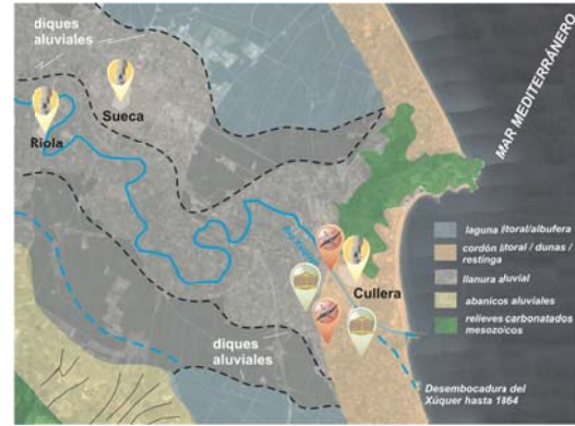
Fig. 37. Reconstrucción paleogeográfica de los diferentes tipos de ambientes sedimentarios en época medieval (de albufera, cordón litoral, llanura aluvial,...) (modificado de Ruiz y Carmona, 2005) con la situación aproximada de los procesos de licuefacción y la aparición de grietas que se produjeron al NE del valle de la Valldigna (Cullera, Sueca y Riola). Las características de los materiales de relleno en estas zonas debieron amplificar los efectos del terremoto, ya que en la documentación se habla de destrucción generalizada d estas poblaciones y de desarrollo de grietas y procesos de licuefacción o (lateral spreading en las proximidades de la población de Cullera).
