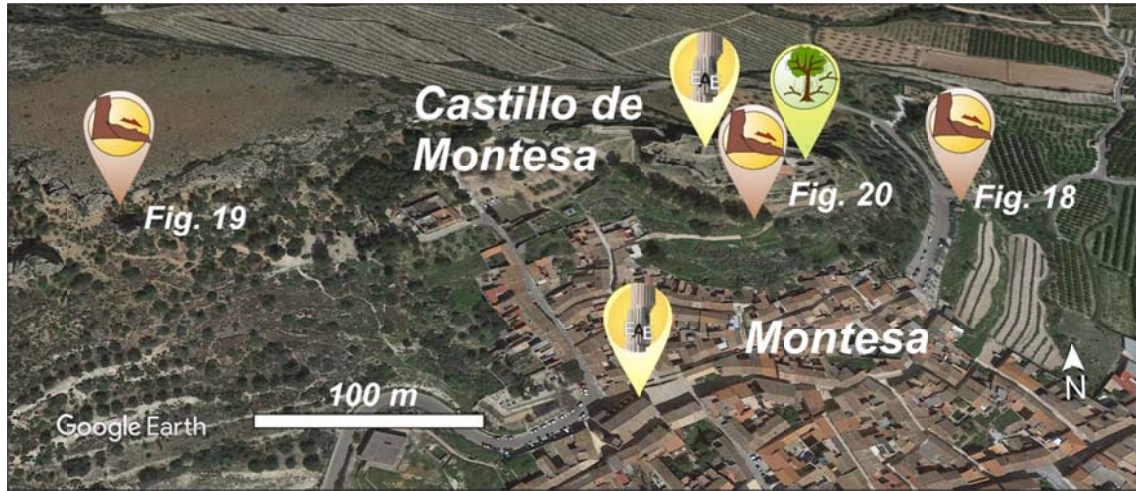
Fig. 16. Diferentes efectos del terremoto en la población de Montesa y sus alrededores. Muchos de los efectos descritos parecen estar relacionados con la movilización y fracturación del paquete de carbonatos sobre el que se asienta el castillo. Estos materiales se apoyan sobre materiales margosos que pudieron ser responsables de una acomodación de los bloques suprayacentes por el movimiento inducido por el sismo, y por tanto responsables últimos de la amplificación de los efectos en la zona del Castillo-Fortaleza.
