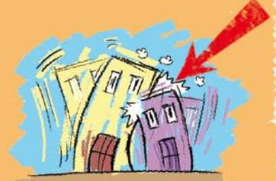
LOS EDIFICIOS DE DIFERENTE ALTURA SI NO **GUARDAN DISTANCIA** SUFICIENTE SE PUEDEN GOLPEAR PELIGROSAMENTE UNOS A OTROS CUANDO LLEGAN LAS ONDAS SÍSMICAS.
