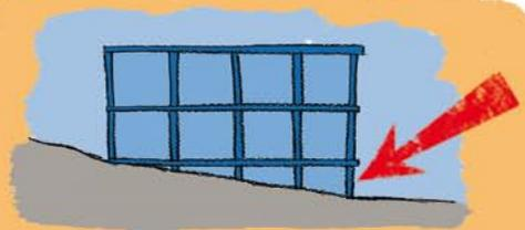
LOS PILARES CORTOS "MATAN", PUEDEN SER RESPONSABLES DEL COLAPSO DEL EDIFICIO. CONCENTRAN TODA LA DEFORMACIÓN.
