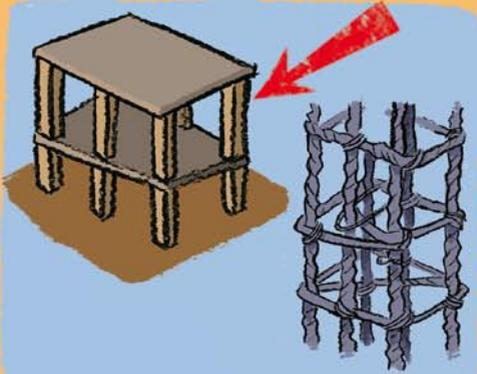
LOS ESTRIBOS SON FUNDAMENTALES PARA QUE LOS PILARES NO SE ROMPAN Y SE DESPLOME EL EDIFICIO, RECORDAD QUE LOS PILARES SON FUNDAMENTALES EN LA ESTABILIDAD DE LA ESTRUCTURA.
