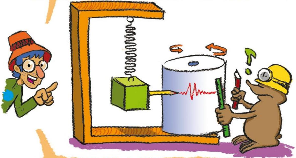
LOS INSTRUMENTOS PARA MEDIR LOS TERREMOTOS SE LLAMAN **SISMÓGRAFOS**. SI LLEGA UN TERREMOTO TODO SE MUEVE, SOLAMENTE EL PESO QUE CUELGA DEL MUELLE PERMANECE INMÓVIL. EN CAMBIO EL TAMBOR GIRATORIO SE MUEVE Y LA PLUMILLA DEJA UNAS MARCAS EN EL PAPEL.
